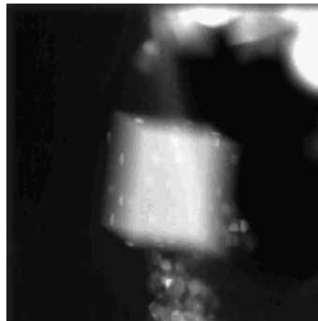
図3 TiN-Agナノ粒子の3次元再構築像．
