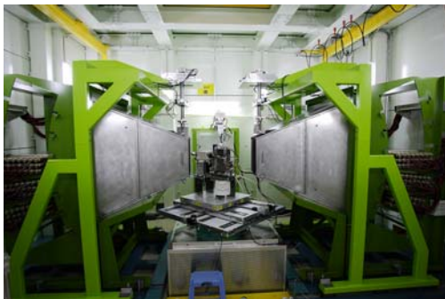
図6 J-PARC 匠に設置した試作熱膨張測定装置
