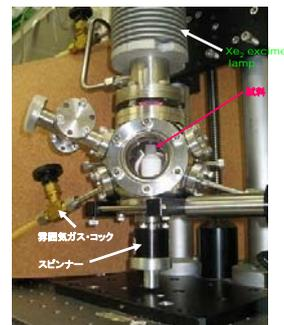
図2 光酸化反応監視装置
