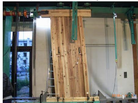
図1 スギ厚板縦板張り耐力壁の実験
