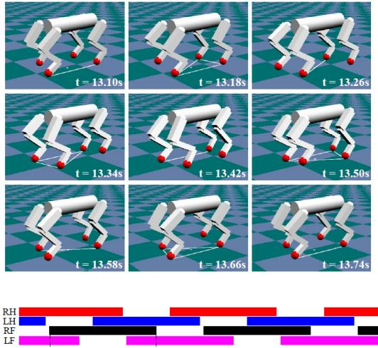
図 1 歩容生成シミュレーション結果 (上)連続歩行スナップショット、(下) 四脚の支持脚相と遊脚相 (安定な walk 歩容が実現されていることが分かる。)
