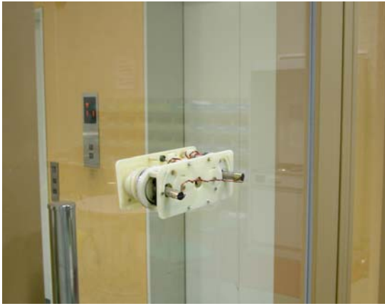
図5 1号機のガラス面吸着のようす
