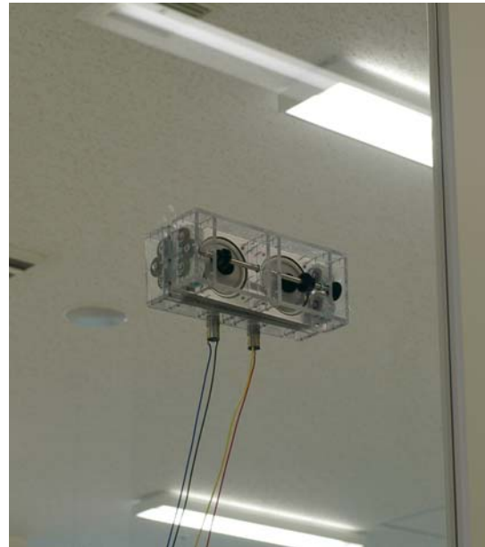
図13 3号機のガラス面走行
