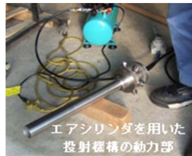
図 12 投射機構の動力部の試作
