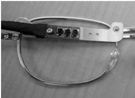
図2 意識的なまばたきを検出するためにメガネフレームに設置したセンサ部
