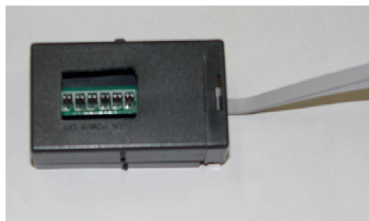
図1 指の動きを検出するためのスイッチの入力部
