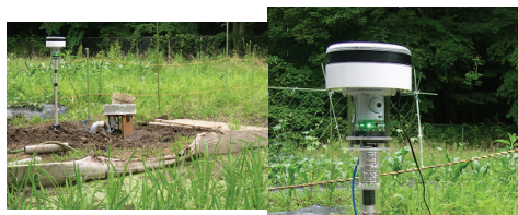
図6 水田に設置したフィールドサーバ
