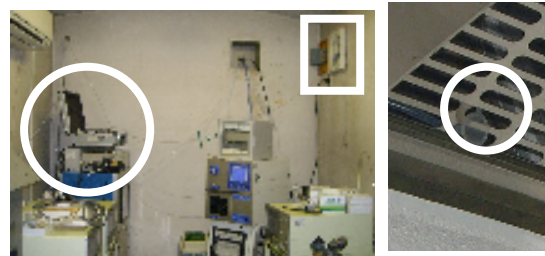
図 12 測定局に設置したSPY-02(左、○部分)の状況、試料大気を導入した換気扇開口部(左、□部)および外部の換気扇フードから見た試料大気インレット部(右、○部)
