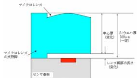
図2 マイクロレンズの設計パラメータ。
