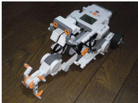
図5. マインドストームを用いた自立型耕作用ロボットの試作機
