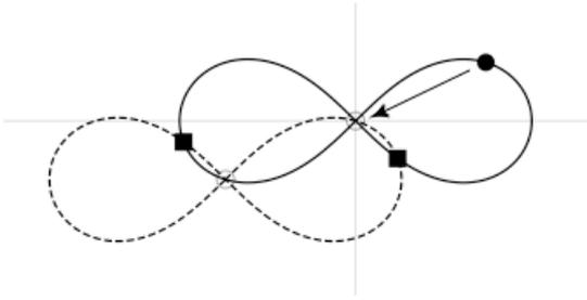
図4. 三点作図定理の8の字形の曲線への応用: 8の字曲線上の, 重心が原点にある三点. 一点(黒丸)を与えたとき, その点が原点に重なるように平行移動したもの(点線の8の字)と, もとの曲線(実線の8の字)との交点が, 求める二点(黒四角). この場合, 白丸で示した二点も交点ではあるが, 黒丸を動かした時の動きが「運動」とは見なせない.
