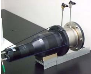
図7 ステンレス製円筒容器（右の白い円筒）に光電子増倍管（左の黒い筒状のもの）を取り付けた装置
