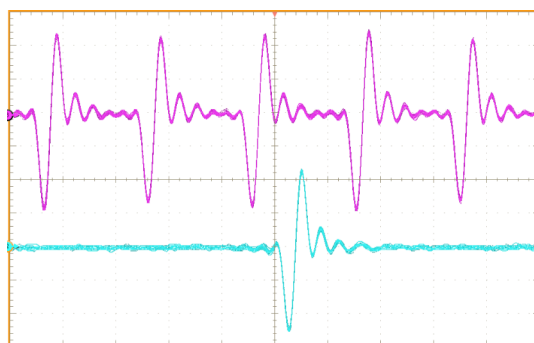
図8：上の波形は静電型電極で検出したバンチトレイン信号、バンチ間隔は2ns、下はゲート回路により、上のバンチトレイン信号から1つのバンチを取り出した波形。横軸の全幅は10ns。
