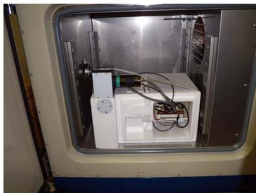
図6. 恒温槽内の試作機。ケースから出し上部に置いてある部分が従来からのフィルター型の光学系部分。その下の円形部分が分光器型の入射用拡散板。
