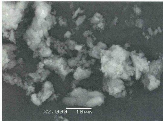
図5 80℃の6モル塩酸に3日間浸漬して得られた非晶質シリカを粉砕した試料のSEM観察写真
