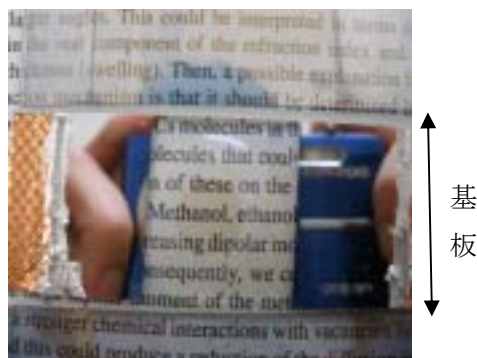
図 12. 試作透明電極 (透過率 86.5%) による本文透過像 (中央)
