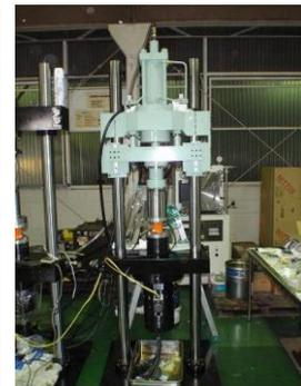
図4 内外圧・軸・ねじり多軸疲労試験装置
