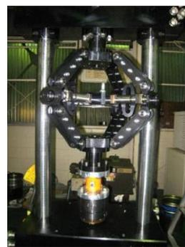
図3 等二軸引張・圧縮試験装置
