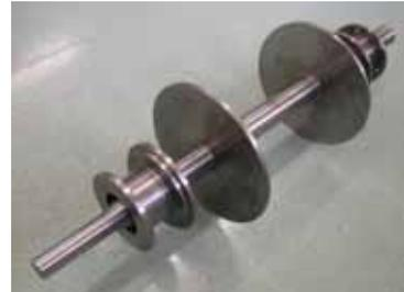
図7 設計・製作した超音波回転体の写真
