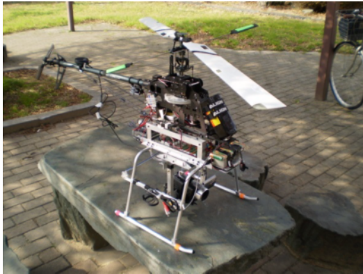
図7 操縦支援システムを組み込んだ小型ラジコンヘリコプタ
