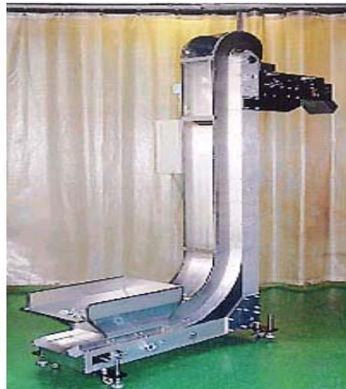
図3 磁力式垂直搬送供給機
