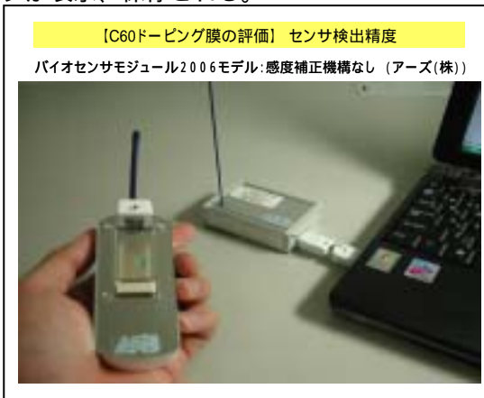
図9 センサ測定機器概観(バイオセンサモジュール2006モデル：アーズ株式会社)
