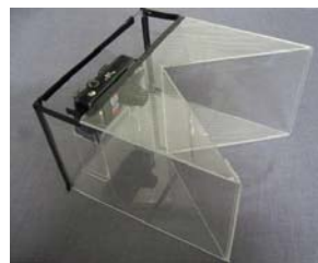
図5. 水中観測用単眼ステレオカメラの構成
