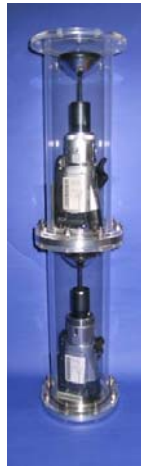
図7. 全方位カメラを用いた水中ステレオシステム
