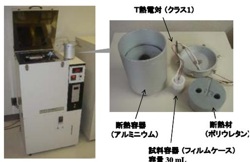
図-4 微小量試料による断熱熱量計
