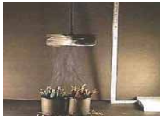
写真-3 攪拌機による煙の拡散(縦に拡散)
