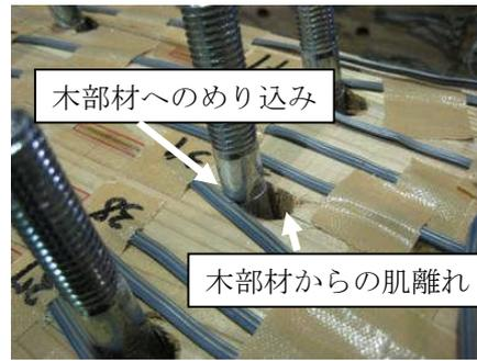
写真-1 ボルト破壊
