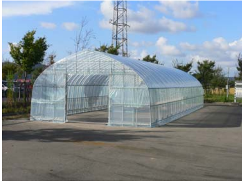
図 2 風圧の実測用に建設された園芸用パイプハウス（秋田県立大学本荘キャンパス）
