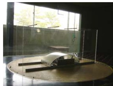
(b) 風洞内に設置された実験模型 図1 屋根強制加振装置と実験模型
