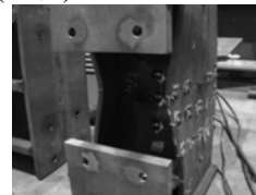
柱フランジの局所変形(弱軸)
