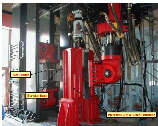
図-1 超高速構造的評価システム —柱梁接合部試験ユニット—
