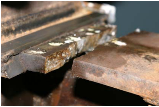
図-7 SS400 材の破断面
