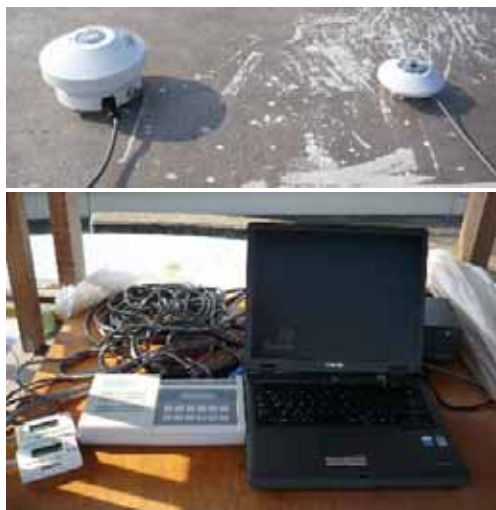
図-2 分光放射計(上段・左) 全天日射計(上段・右) 温湿度計と制御用 PC(下段)
