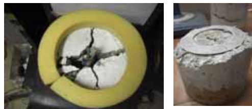
写真6 実験後の破砕状態（鉄筋かごは使用 していない）
