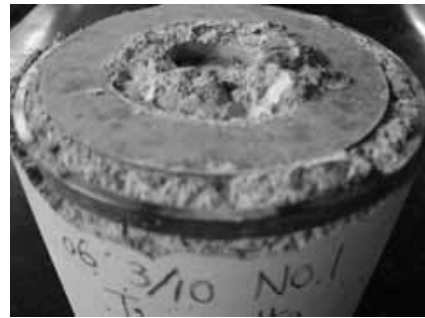
写真4 コンクリート柱状試験体の 破断面形成状態
