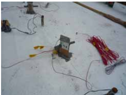
写真2 装薬装填後のホルダー上面
