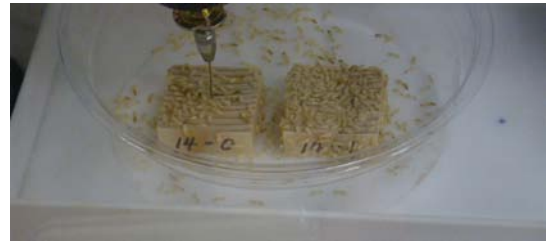
図 4 イエシロアリに対するネバダオオシロアリ種固有振動パターンの投与による行動攪乱
