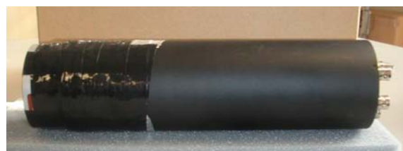
図2 光電子増倍管と接合されたシンチレータ
