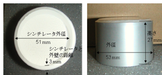
図1 BGO シンチレータの寸法
