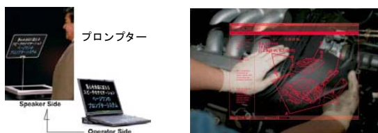
図1 内部のパーツをスーパーインポーズさせ、内部構造を把握する
