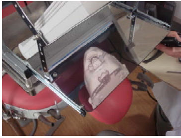
図4 ハーフミラーにCAD顔モデルを表示したところ
