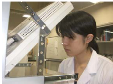
図6 鼻先のマーカーによりCADモデルを回転させる
