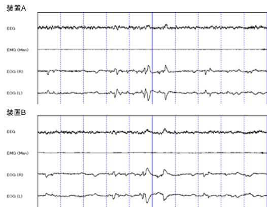
レム睡眠時の生体現象の比較の例 (装置 A：無線テレメータシステム，装置 B：携帯型アンプを用いた生体現象記録システム)
