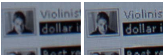
図7. 重畳投影の実現例。左：1台，右：8台の重畳投影による。
