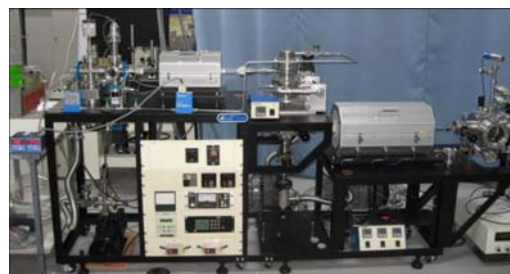
図 1. 実験装置の写真。レーザーアブレーションで生成したナノ粒子をサイズ選別する DMA と CVD 装置の組み合わせとなっている。
