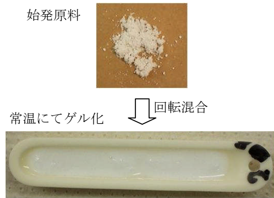
図1 出発原料の常温ゲル化
