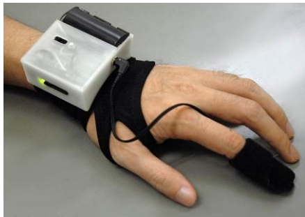
図2 脈波・加速度計測に基づく生体リズム推定を実現したBRAC4: Biological Rhythm-based Awakening Controller 4
