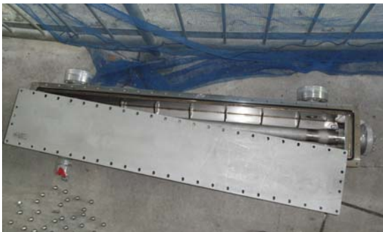
図 3: 黒鉛粉末標的の試験用ヘリウム容器 容器内部に取り付けた配管内部に試作した標的を設置する。
