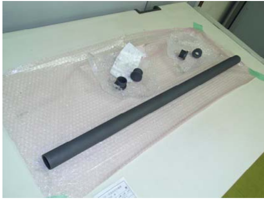
図 2: 試作した黒鉛製容器(長さ 900mm, 外径 38.2mm, 肉厚 3.55mm)
