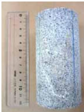
図1. 載荷後の試料の様子。試料表面に成長途上の断層を確認することができる。
