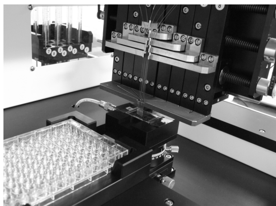
図 2 : 開発した 8 連キャピラリー式ピッチ可変型アレイスポット
