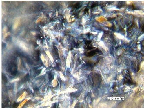
Fig 2. Poly(MBMA)薄膜のクロスニコル下の偏光顕微鏡像 (x1000)
