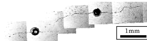
(b) 異なる平面上に存在する場合 図 5 予き裂外観（レプリカ）
