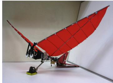
図6：羽ばたき飛行ロボット
