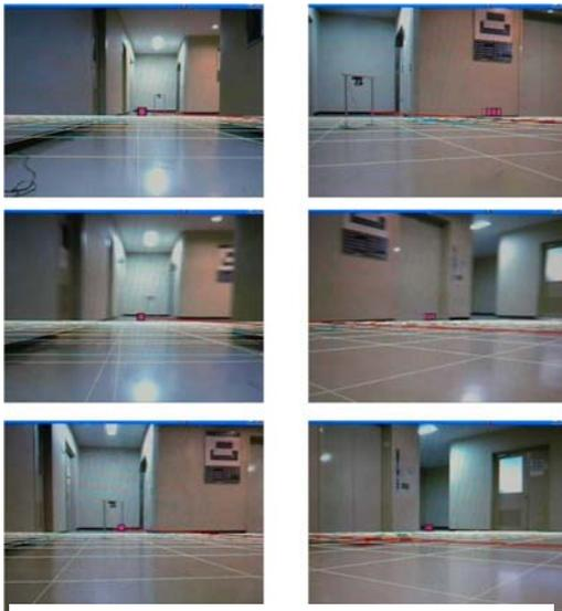
図 6 注視点をジョイスティックにより移動させた場合の視線自動選択例。各画像中の立方体が注視点であり、この注視点を中心に捉える画像が自動的に選択されている。
