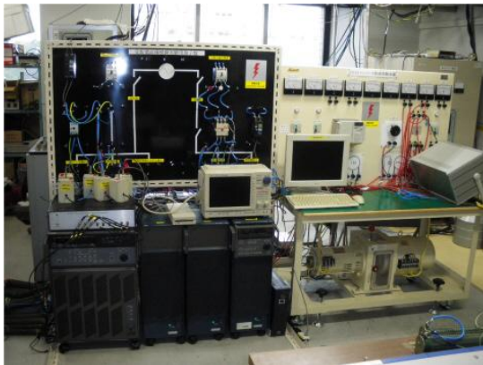
図3 実証試験用マイクログリッドモデル
