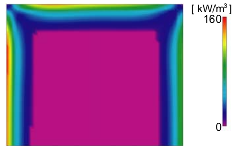
図 17 環状試料の渦電流損失の解析例 (100Hz)
