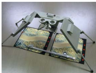
写真-1 実体鏡、視差桿と2枚1組のアナログ航空写真
