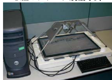
写真-2 実体鏡とデジタル化航空写真
